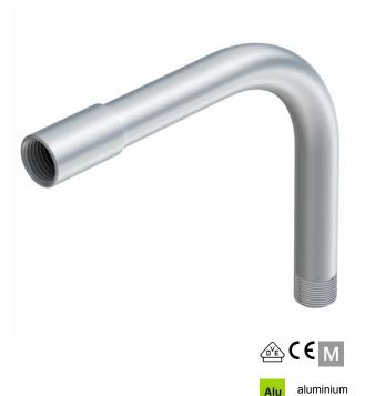
Coude à  $90^\circ$  pour les tubes électriques selon EN 61386-1, équipés d'extrémités filetées selon DIN EN 60423. Avec paroi intérieure sans bavures.
