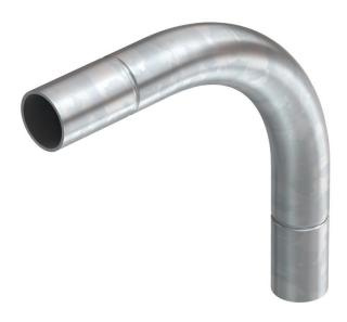
Raccordo a gomito  $90^\circ$  con manicotti modellati per tubi di installazione elettrica secondo EN 61386-1. Parete interna senza sbavature.
