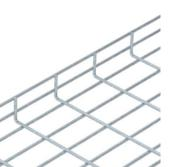
Passerella grigliata composta da fili in acciaio saldati a punto con bordo di altezza pari a 55 mm. La dimensione delle maglie è di 50 x 100 mm. Schermatura elettromagnetica senza coperchio 15 dB, con coperchio 25 dB.
