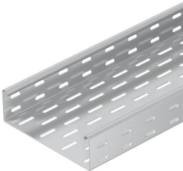
SKS 60 = Système de chemins de câbles lourd d'une hauteur latérale de 60 mm. Les raccords doivent être commandés séparément en quantité nécessaire. Atténuation magnétique du blindage sans couvercle 20 dB, avec couvercle 50 dB.
