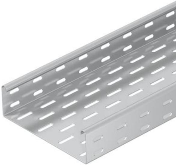
SKS 60 = Système de chemins de câbles lourd d'une hauteur latérale de 60 mm. Le chemin de câbles type SKS peut également être utilisé pour le maintien en fonction. Pour d'autres informations, se reporter aux systèmes de protection contre les incendies BSS ; Kit d'éclissage droit type RV 60 inclus dans la livraison. Ce chemin de câbles est fixé sur la console à l'aide de vis à tête bombée FRS M6 x 12. Atténuation magnétique du blindage sans couvercle 20 dB, avec couvercle 50 dB.
