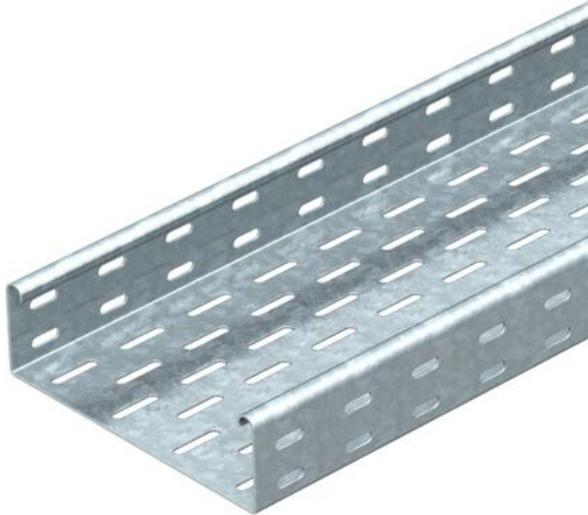
SKS 60 = Système de chemins de câbles lourd d'une hauteur latérale de 60 mm. Le chemin de câbles type SKS peut également être utilisé pour le maintien en fonction. Pour d'autres informations, se reporter aux systèmes de protection contre les incendies BSS ; Kit d'éclissage droit type RV 60 inclus dans la livraison. Atténuation magnétique du blindage sans couvercle 20 dB, avec couvercle 50 dB.
