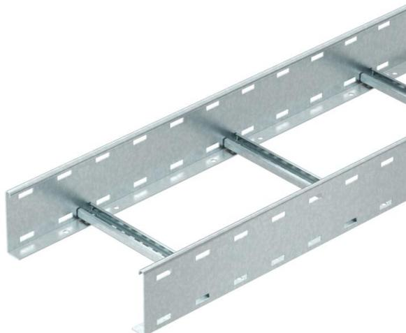
Échelle à câbles d'une hauteur latérale de 110 mm avec échelons soudés à profilé C30 ouvert vers le haut. Longeron latéral enroulé pour le renforcement et la protection des bords. La fixation sur console s'effectue avec des pièces de serrage de type LKS 40. La fente de l'échelon mesure 16,5 mm. La bride de fixation correspondante est de type 2056.
