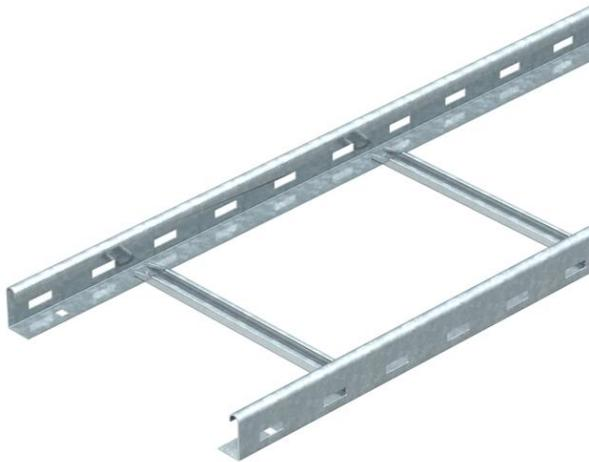
Échelle à câbles avec longeron perforée d'une hauteur latérale de 45 mm, avec échelons rivetés, échelons en C ouverts vers le haut. L'échelle à câbles est livrée repliée. Vous trouverez la bride de fixation rapide adaptée de type 2056N dans la section des systèmes d'échelles verticales. Atténuation magnétique du blindage sans couvercle 10 dB, avec couvercle 15 dB.
