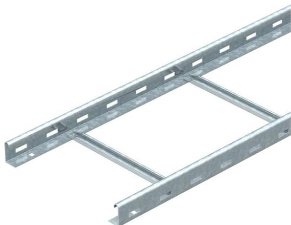
Kabelleiter mit gelochtem Seitenholm in der Seitenhöhe 45 mm mit eingiebeten, nach oben offenen C-Profil-Sprossen.
