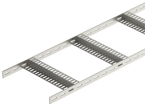
Passerella leggera per impianti navali con longherone laterale forato con bordo di altezza pari a 35 mm con pioli saldati, forati, a Z. Carico testato secondo IEC in combinazione con connettore tipo SLV.
