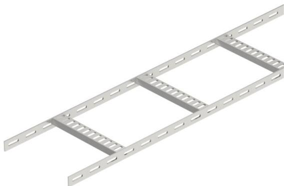
Passerella a scaletta per impianti navali con longherone laterale forato con bordo di altezza pari a 25 mm con pioli trapezoidali saldati, forati, aperti verso il basso. Carico testato secondo IEC in combinazione con connettore tipo SLV. La passerella per impianti navali è disponibile su richiesta anche in acciaio grezzo.
