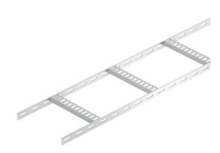
Échelle à câbles dédiée à la construction navale avec longeron latéral perforé d'une hauteur latérale de 25 mm, avec échelons trapézoïdales soudés et perforées, ouverts vers le bas. Sur demande, l'échelle à câbles version navale est également livrable en acier
