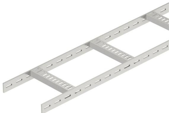
Échelle à câbles pour construction navale avec longeron perforé d'une hauteur latérale de 40 mm, avec échelons trapézoïdales soudés et perforés, ouverts vers le bas. Charge testée selon CEI en combinaison avec les raccords de type SLV.
