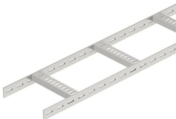
Passerella a scaletta per impianti navali con longherone laterale forato con bordo di altezza pari a 40 mm con pioli trapezoidali saldati, forati, aperti verso il basso. Carico testato secondo IEC in combinazione con connettore tipo SLV. La passerella per impianti navali è disponibile su richiesta anche in acciaio grezzo.
