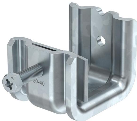
Questo tipo di graffe di supporto viene spinto sulle travi e fissato con coppa e vite (M8) alla trave o ai profilati piatti. La vite a testa esagonale ha un'apertura di chiave di 10 mm. Nella graffa sono inoltre presenti due altre filettature M8, per fissare per esempio delle aste filettate.
