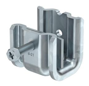
Ce type de pince de fixation est poussé sur le support et fixé sur le support ou un fer plat au moyen d'un patin de pression et d'une vis (M8). La vis hexagonale est dotée d'une ouverture de clé 10 mm. En outre, dans le corps de bride, deux autres filets M6 sont prévus pour fixer entre autres des tiges filetées.
