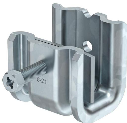
Questo tipo di graffe di supporto viene spinto sulle travi e fissato con coppa e vite (M8) alla trave o ai profilati piatti. La vite a testa esagonale ha un'apertura di chiave di 10 mm. Nella graffa sono inoltre presenti due altre filettature M8, per fissare per esempio delle aste filettate.
