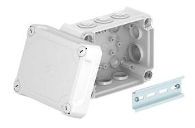
Boîtier de dérivation pour le raccordement de câbles et de lignes en intérieur et en extérieurs protégés. Forme rectangulaire avec des joints d'étanchéité sur les côtés et des ouvertures prédécoupées défonçables dans le fond. Convient pour le montage au mur/au plafond et sur des tôles de montage. Avec possibilité de fixation intérieure et de montage au dessus des dômes angulaires. Couvercle haut avec fermeture rapide, plombable. Fabriqué à partir de matériaux sans halogène et résistants aux UV.
