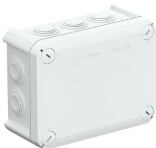
Boîtier de dérivation selon la norme DIN EN 60670. Ignifugé selon la norme DIN EN 60695-2-11, température d'essai 650 °C. Résistance aux chocs IK07 selon la norme DIN EN 50102.
