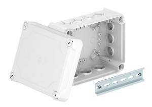
Scatola di derivazione per il collegamento di cavi e linee in ambienti interni e ambienti esterni protetti. Forma rettangolare con tenute a innesto sui lati e inserti di deviazione nel fondo. Adatta per il montaggio su pareti e soffitti e il montaggio su piastre di montaggio. Con la possibilità di fissaggio interno e montaggio su sezioni angolari. Coperchio alto con chiusura rapida, piombabile. Costruita con materiali privi di alogeni e stabilizzati ai raggi UV.
