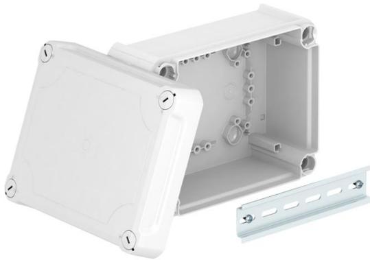
Boîtier de dérivation fermé pour le raccordement de câbles et de lignes en intérieur et en extérieurs protégés. Forme rectangulaire sans ouvertures. Convient pour le montage au mur/au plafond et sur des tôles de montage. Avec possibilité de fixation intérieure et de montage au dessus des dômes angulaires. Couvercle haut avec fermeture rapide, plombable. Fabriqué à partir de matériaux sans halogène et résistants aux UV.
