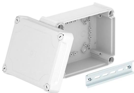
Scatola di derivazione chiusa per il collegamento di cavi e linee in ambienti interni e ambienti esterni protetti. Forma rettangolare senza ingressi. Adatta per il montaggio su pareti e soffitti e il montaggio su piastre di montaggio. Con la possibilità di fissaggio interno e montaggio su sezioni angolari. Coperchio alto con chiusura rapida, piombabile. Costruita con materiali privi di alogeni e stabilizzati ai raggi UV.
