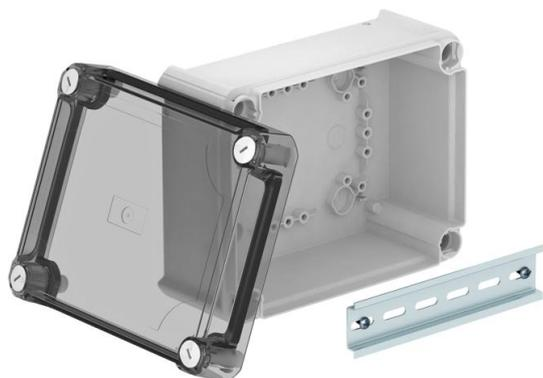
Scatola di derivazione chiusa per il collegamento di cavi e linee in ambienti interni e ambienti esterni protetti. Forma rettangolare senza ingressi. Adatta per il montaggio su pareti e soffitti e il montaggio su piastre di montaggio. Con la possibilità di fissaggio interno e montaggio su sezioni angolari. Coperchio alto e trasparente con chiusura rapida, piombabile. Costruita con materiali privi di alogeni e stabilizzati ai raggi UV.
