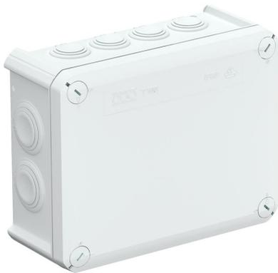
Boîtier de dérivation pour le raccordement de câbles et de lignes en intérieur et en extérieurs protégés. Forme rectangulaire avec des joints d'étanchéité sur les côtés et des ouvertures prédécoupées défonçables dans le fond. Convient pour le montage au mur/au plafond et sur des tôles de montage. Avec possibilité de fixation intérieure et de montage au dessus des dômes angulaires. Couvercle avec fermeture rapide, plombable. Fabriqué à partir de matériaux sans halogène et résistants aux UV.
