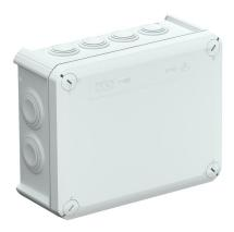
Scatola di derivazione per il collegamento di cavi e linee in ambienti interni e ambienti esterni protetti. Forma rettangolare con tenute a innesto sui lati e inserti di deviazione nel fondo. Adatta per il montaggio su pareti e soffitti e il montaggio su piastre di montaggio. Con la possibilità di fissaggio interno e montaggio su sezioni angolari. Coperchio con chiusura rapida, piombabile. Costruita con materiali privi di alogeni e stabilizzati ai raggi UV.
