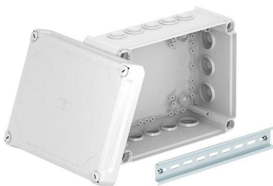
Scatola di derivazione per il collegamento di cavi e linee in ambienti interni e ambienti esterni protetti. Forma rettangolare con tenute a innesto sui lati e inserti di deviazione nel fondo. Adatta per il montaggio su pareti e soffitti, il montaggio su piastre di montaggio e filettatura nel pavimento. Con la possibilità di fissaggio interno e montaggio su sezioni angolari. Coperchio alto con chiusura rapida, piombabile. Costruita con materiali privi di alogeni e stabilizzati ai raggi UV.
