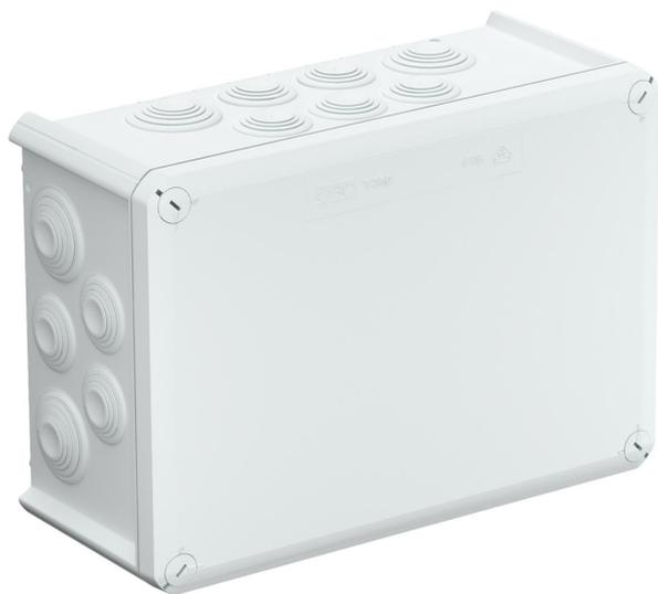
Scatola di derivazione per il collegamento di cavi e linee in ambienti interni e ambienti esterni protetti. Forma rettangolare con tenute a innesto sui lati e inserti di deviazione nel fondo. Adatta per il montaggio su pareti e soffitti e il montaggio su piastre di montaggio. Con la possibilità di fissaggio interno e montaggio su sezioni angolari. Coperchio con chiusura rapida, piombabile. Costruita con materiali privi di alogeni e stabilizzati ai raggi UV.
