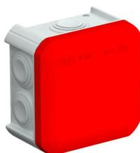
Scatola di derivazione per il collegamento di cavi e linee in ambienti interni e ambienti esterni protetti. Forma quadrata con tenute a innesto sui lati e inserti di derivazione nel pavimento. Adatta per il montaggio su pareti e soffitti e il montaggio su piastre di montaggio. Con la possibilità di fissaggio interno. Con coperchio a scatto fisso. Costruita con materiali halogen free e resistente ai raggi UV.
