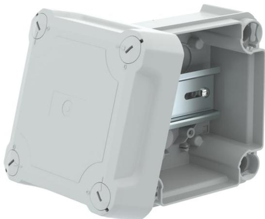
Scatola di derivazione chiusa per il collegamento di cavi e linee in ambienti interni e ambienti esterni protetti. Forma quadrata senza ingressi. Adatta per il montaggio su pareti e soffitti e il montaggio su piastre di montaggio. Con la possibilità di fissaggio interno e montaggio su sezioni angolari. Coperchio alto con chiusura rapida, piombabile. Costruita con materiali privi di alogeni e stabilizzati ai raggi UV.
