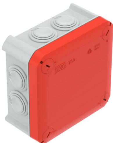
Boîtier de dérivation pour le raccordement de câbles et de lignes en intérieur et en extérieurs protégés. Forme carrée avec des joints d'étanchéité sur les côtés et des ouvertures prédécoupées défonçables dans le fond. Convient pour le montage au mur/au plafond et sur des tôles de montage. Avec possibilité de fixation intérieure et de montage au dessus des dômes angulaires. Couvercle avec fermeture rapide, plombable. Fabriqué à partir de matériaux sans halogène et résistants aux UV.
