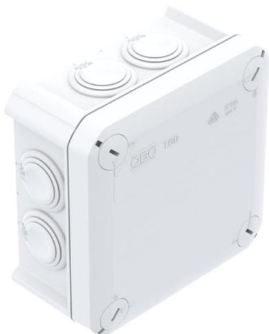
Boîtier de dérivation pour le raccordement de câbles et de lignes en intérieur et en extérieurs protégés. Forme carrée avec des joints d'étanchéité sur les côtés et des ouvertures prédécoupées défonçables dans le fond. Convient pour le montage au mur/au plafond et sur des tôles de montage. Avec possibilité de fixation intérieure et de montage au dessus des dômes angulaires. Couvercle avec fermeture rapide, plombable. Fabriqué à partir de matériaux sans halogène et résistants aux UV.
