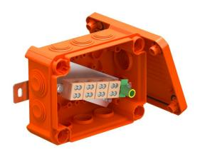
Kabelabzweigkasten mit keramischen Doppelklemmen und weichen Einsteckdichtungen. Ausreichender Verdrahtungsraum durch diagonal angeordnete Anschlusseinheit mit komplett vormontierten hochtemperaturbeständigen Keramikklemmen. Grün-gelb gekennzeichnete Schutzleiterklemme. Befestigung an gut zugänglichen Außenlaschen. Zugelassen für Kabelanlagen mit elektrischem Funktionserhalt nach DIN 4102 Teil 12 mit den Klassen E30, E60 und E90. Keramikklemmen wurden nach DIN EN 60998-2-1:2004 geprüft.
