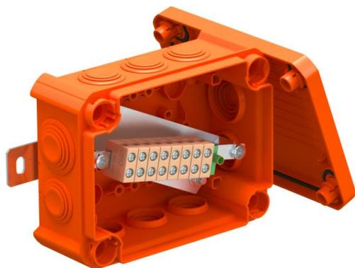
Scatola di connessione per linee dati con tenute a innesto morbide. Coppie di morsetti in ceramica resistenti alle alte temperature idonee per linee dati. Morsetto di schermatura/condotto di protezione contrassegnato in giallo-verde. Fissaggio a linguette esterne ben accessibili. Omologazione per impianti di cavi con mantenimento funzionale elettrico a norma DIN 4102 parte 12 nelle classi E30, E60 e E90. I morsetti in ceramica sono stati testati a norma DIN EN 60998-2-1:2004.
