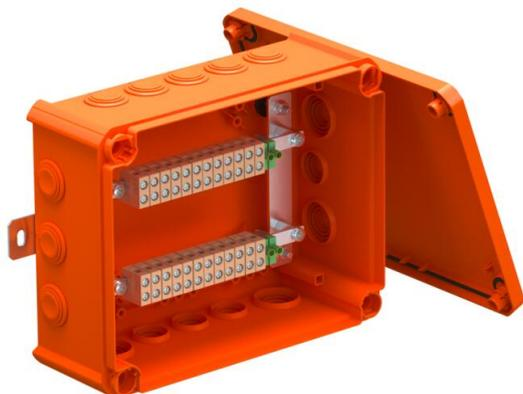
Scatola di connessione per linee dati con tenute a innesto morbide. Coppie di morsetti in ceramica resistenti alle alte temperature idonee per linee dati. Morsetto di schermatura/conduttore di protezione contrassegnato in giallo-verde. Fissaggio a linguette esterne ben accessibili. Omologazione per impianti di cavi con mantenimento funzionale elettrico a norma DIN 4102 parte 12 nelle classi E30, E60 e E90. I morsetti in ceramica sono stati testati a norma DIN EN 60998-2-1:2004.
