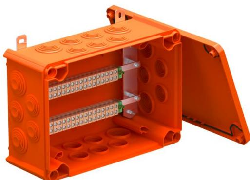
Scatola di connessione per linee dati con tenute a innesto morbide. Coppie di morsetti in ceramica resistenti alle alte temperature idonee per linee dati. Morsetto di schermatura/conduttore di protezione contrassegnato in giallo-verde. Fissaggio a linguette esterne ben accessibili. Omologazione per impianti di cavi con mantenimento funzionale elettrico a norma DIN 4102 parte 12 nelle classi E30, E60 e E90. I morsetti in ceramica sono stati testati a norma DIN EN 60998-2-1:2004.
