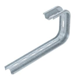
Staffa a soffitto e a parete TP per il fissaggio universale. Attenzione! Se la staffa viene fissata direttamente alla parete o al soffitto, per motivi di stabilità, è sempre necessario utilizzare il distanziatore del tipo DS 4. Altezza laterale massima del sistema portacavi 60 mm.
