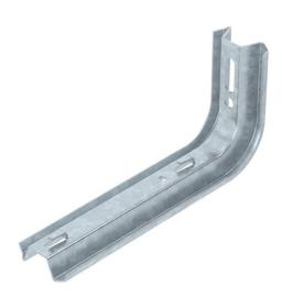
Console TP avec ergots de fixation. Si la console est fixée directement sur le mur ou si les profilés sont vissés les uns contre les autres, il convient pour des raisons de stabilité d'utiliser systématiquement l'entretoise type DS 4.
