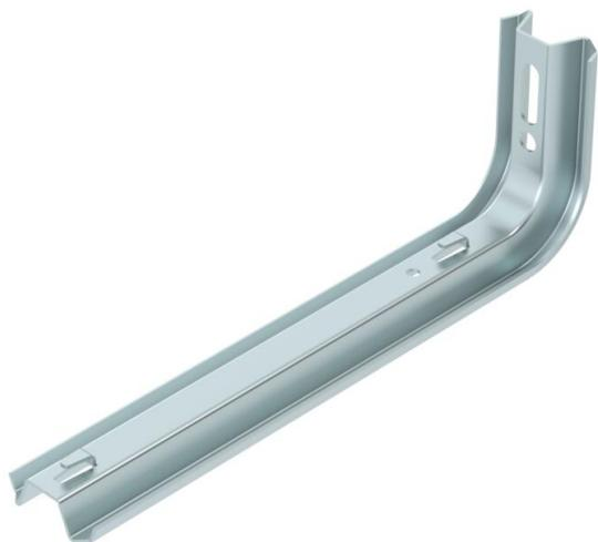
TP-Ausleger mit Klemmaschen zur schraubenlosen Gitterinnenbefestigung. Wird der Ausleger direkt an der Wand befestigt oder werden die Profile gegeneinander geschraubt, so ist aus Stabilitätsgründen immer das Distanzstück Typ DS 4 einzusetzen. Auf dem TP-Ausleger können Gitterrinnen mit der Maschenweite 50 x 100 mm z. B. Typ GRL, GR und GRM schraubenlos befestigt werden.
