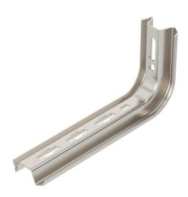
Pendard / console TP à fixer sur les plafonds en béton horizontaux et aux murs. Si le profilé est fixé au plafond ou s'il est vissé contre la tête pour la renforcer, il convient pour des raisons de stabilité d'utiliser systématiquement l'entretoise de type DS 4.
