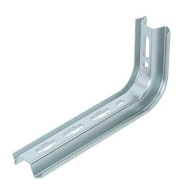
Profilé TP à utiliser comme pendard léger sur les plafonds en béton horizontaux, longueur 145 à 645 mm. Jusqu'à la longueur de 345 mm, le profilé est également utilisé comme console murale ou de pendard légère.
