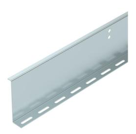
Séparateur pour système de chemins de câbles praticables BKRS. Fixation au moyen des vis à tête bombéee M 6 x 12 mm dans le fond perforé. À partir d'une largeur de 200 mm, utiliser un séparateur avec un compartiment de 220 mm max.
