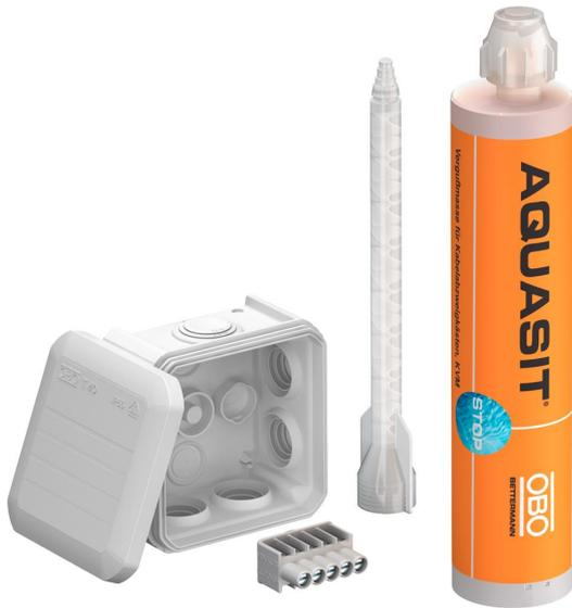
Set boîte de dérivation avec bornier pour le raccordement des câbles et des conduites en intérieur et en extérieur protégé. Avec masse de scellement à froid Aquasit, degré de protection IP 68. Forme carrée avec des joints d'étanchéité sur les côtés et des ouvertures prédécoupées défonçables dans le fond. Convient pour le montage au mur/au plafond et sur des tôles de montage. Avec possibilité de fixation intérieure. Avec couvercle fixe à encliqueter. Fabriqué à partir de matériaux sans halogène.
