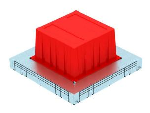
Scatola apparecchi sotto pavimento con apertura di montaggio fissa e non modificabile per una unità di montaggio della grandezza nominale 9. L'apertura di montaggio viene ricavata mediante un guscio fornito in dotazione. La scatola da incasso è dotata di aperture di inserimento per canali sotto pavimento a 2 o 3 vie in lamiera d'acciaio, su tutti i quattro lati.
