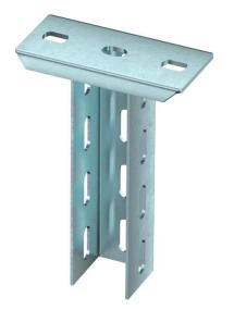
Profilato di sospensione (profilato a U) con supporto a soffitto saldato. Per il fissaggio a soffitti in calcestruzzo orizzontali e supporti in acciaio. Nel caso si utilizzino mensole di lunghezza 400 millimetri o oltre oppure si montino le mensole alla fine del supporto di sospensione si consiglia di utilizzare il distanziatore, tipo DSK 45
