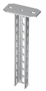
Profilato di sospensione (profilato a U) con supporto a soffitto saldato. Per il fissaggio a soffitti in calcestruzzo orizzontali e supporti in acciaio. Nel caso si utilizzino mensole di lunghezza 400 millimetri o oltre oppure si montino le mensole alla fine del supporto di sospensione si consiglia di utilizzare il distanziatore, tipo DSK 61.
