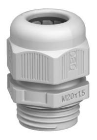
Il modo più rapido e agevole per installare pressacavi su scatole di derivazione cavi e alloggiamenti per dispositivi antistrappo e guarnizioni: i pressacavi V-TEC VM con efficacia collaudata di OBO. Grazie alle alette di tenuta e alla speciale tecnica a lamelle di OBO i prodotti sono conformi alla classe di protezione IP68. Le prove di tenuta e trazione sono effettuate secondo la norma EN 62444
