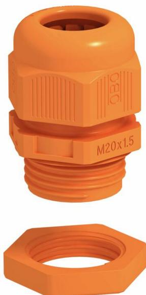
Pressacavo robusto con tipologia costruttiva a dado cieco e filettatura di raccordo metrica secondo IEC 423, incluso controdatado premontato.
