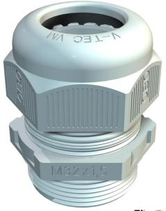
Il modo più rapido e agevole per installare pressacavi su scatole di derivazione cavi e alloggiamenti per dispositivi antistrappo e guarnizioni: i pressacavi V-TEC VM con efficacia collaudata di OBO. Grazie alle alette di tenuta e alla speciale tecnica a lamelle di OBO i prodotti sono conformi alla classe di protezione IP68. Le prove di tenuta e trazione sono effettuate secondo la norma EN 62444
