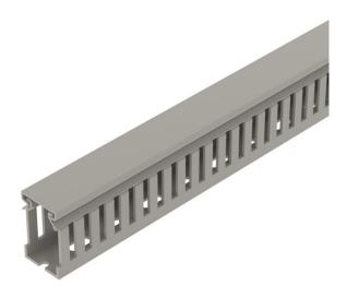
Canale di cablaggio, incl. parte superiore e foratura nel fondo per posa orizzontale e verticale di cavi e linee elettriche nel quadro elettrico. La separazione delle linguette avviene senza utensili. Lunghezze speciali su richiesta. Controllato secondo DIN EN 50085-2-3. Parte inferiore e superiore nel set.
