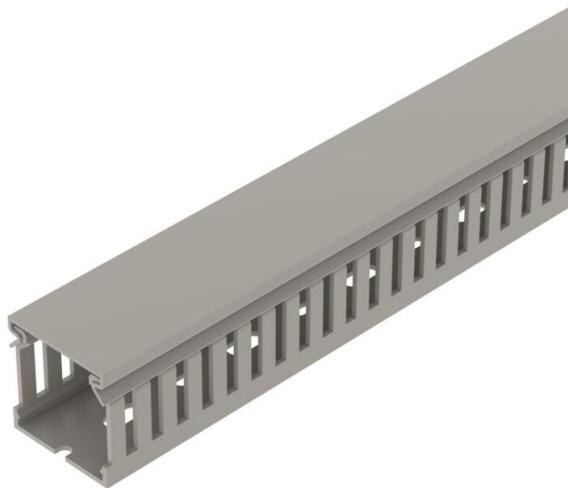
Verdrahtungskanal inkl. Oberteil und Bodenlochung zur waagerechten und senkrechten Verlegung elektrischer Kabel und Leitungen im Schaltschrank. Das Ausbrechen der Stege erfolgt werkzeuglos. Sonderlängen auf Anfrage. Geprüft nach DIN EN 50085-2-3. Unter- und Oberteil im Set.
